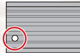
本体両端に開いている穴を使って、木ネジで作業台に固定できます。
